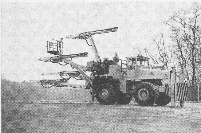
Vierarmiger SIG-Bohrwagen mit Ladkorb auf Knickgelenkfahrzeug, Type BAP 4-380 + L, mit Wirkungsfläche bis 47 m 2 Profilquerschnitt
