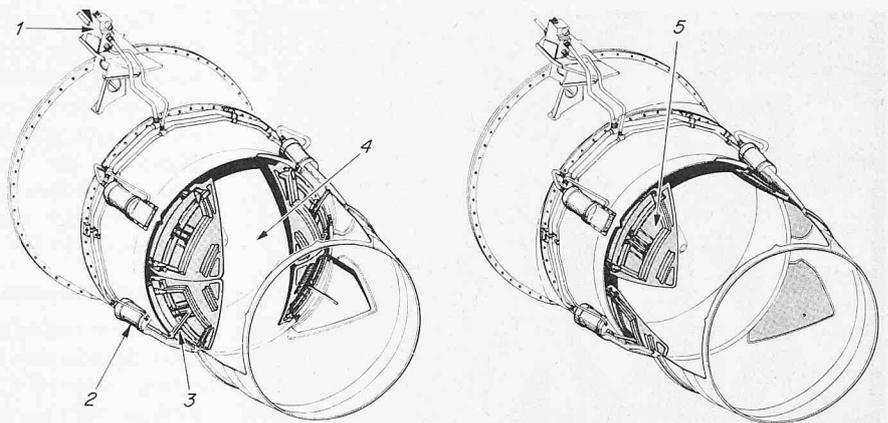
Moduln (Bild 12). Die meisten dieser Baugruppen können ausgewechselt werden, ohne das man das Triebwerk ausbauen muss. Mit dieser Bauart wird im Wartungsablauf der Übergang von den festen Zeiten zwischen den Überholungen auf ein zustandsbedingtes Programm vollzogen. Mit Hilfe von fest eingebauten Führungsschienen können die meisten Hauptbaugruppen in wenigen Stunden ausgetauscht werden.
