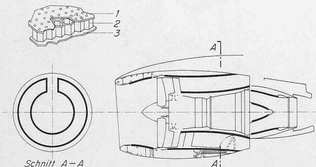
Bild 7. Anordnung der schallschluckenden Verschalungen beim Triebwerk RB. 211. Die Gesamtfläche beträgt 18,5 m<sup>2</sup>. Links oben: Darstellung der wabenförmigen Konstruktion der Verschalung
