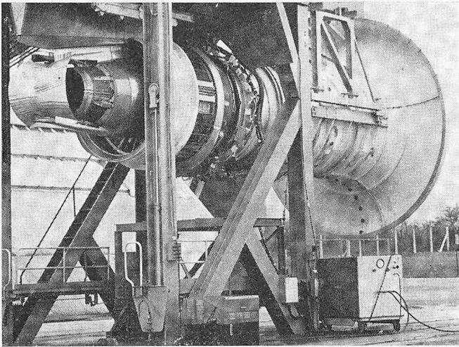
Bild 10. Das Triebwerk in Schubumkehrstellung auf dem Prüfstand
