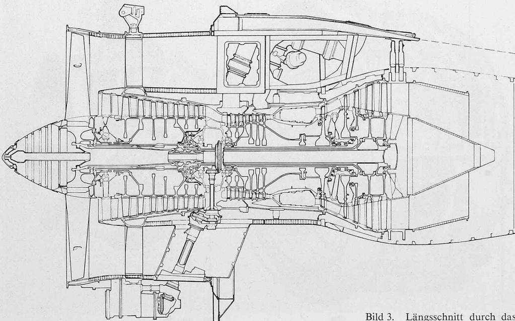
Bild 3. Längsschnitt durch das Triebwerk Rolls-Royce RB. 211
