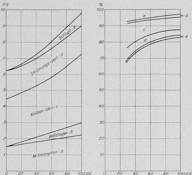
Bild 1. Wirkungsgrad eines Lauf-Thoma-Getriebes von  $N = 45$  PS,  $n = \pm 300$  U/min, Hub 22 mm. Links: Einzelne Teilverluste in PS in Funktion vom Betriebsdruck. Rechts: Einfluss der Teilverluste auf den Wirkungsgrad
