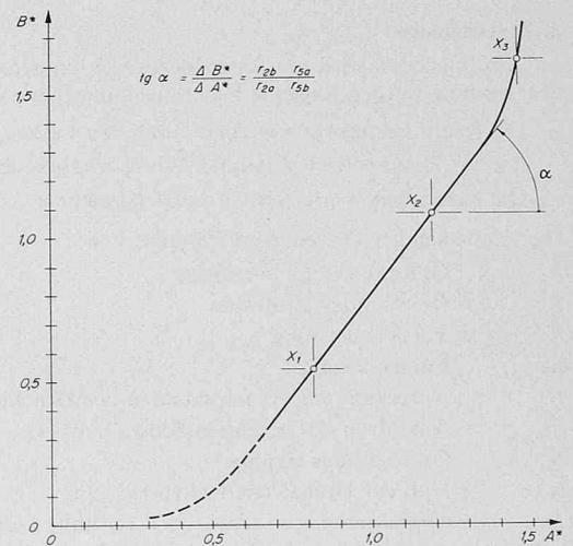
Bild 3. Zuordnungskurve der Leitapparat- und Laufschaufelstellung einer Kaplan-Turbine
