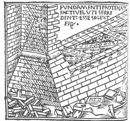
Fachwerkartige Versteifung von Stadtmaueranlagen. Aus M. Vitruvius «De architectura libri decem», Lyon, 1523
