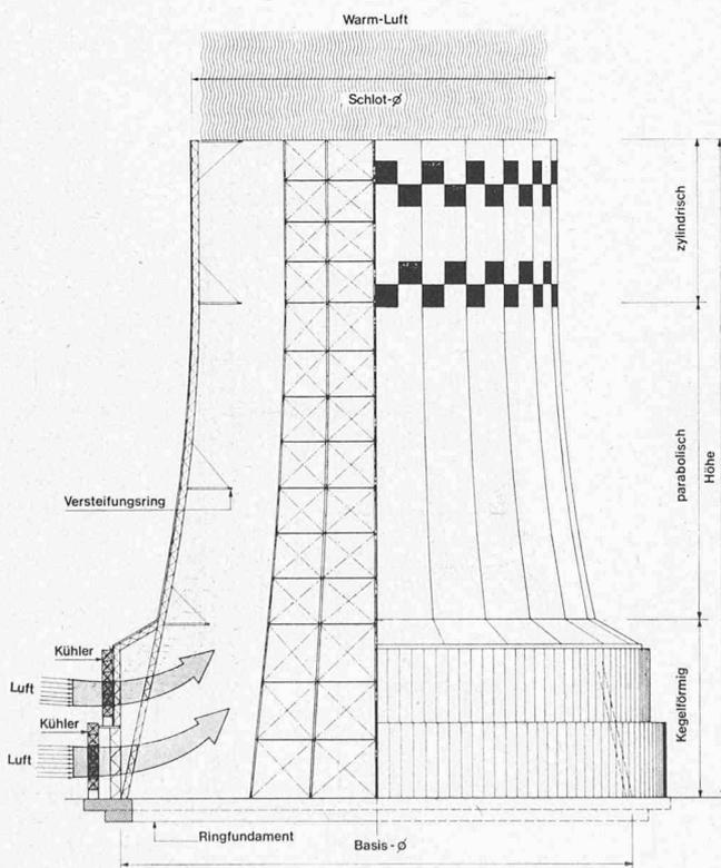
Bild 1. Naturzug-Trockenkühlturm in Stahlfachwerkkonstruktion mit Aluminiumverkleidung, Typ Alesa
