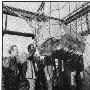
Umfassende Tests vor internationalen Sicherheitsexperten erbrachten durchwegs positive Resultate. Tonnenschwere Betonblöcke wurden aus 20 m Höhe fallen gelassen: Bei 72 km/h Aufschlaggeschwindigkeit hielten die Brugg Drahtseilnetze dieser Belastung stand – das neue Bremsselement an den Verankerungspunkten hat die gewaltigen Energien aufgezehrt und den Schlägen getrotzt!
