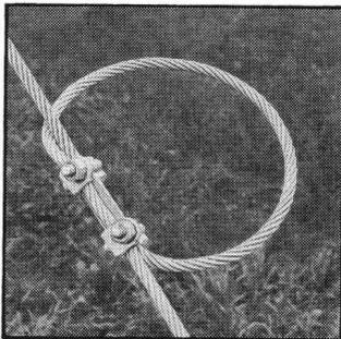
Dieses neue Bremsselement wird in die Aufhängeseile eingebaut. Es absorbiert die Energie und hält die übertragenen dynamischen Kräfte klein. Die Schutzwirkung wird dadurch bei geringem Kostenaufwand wesentlich erhöht. Das Bremsselement (Patent angemeldet) lässt sich in jedes schlagbeanspruchte Drahtseil einbauen, auch überall dort, wo die maximale Last begrenzt werden soll.
