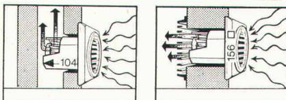
Der kleinste, preisgünstigste Druckventilator mit der grossen Leistung: 100 m<sup>3</sup>/h. Für Neubauten und nachträglichen Einbau an bestehende Luftkanäle. Lageunabhängig. Modelle für Einbaurohre von 100 und 115 mm  $\varnothing$ , mit oder ohne Verschluss, Kontrolllampe und Zugschalter.
