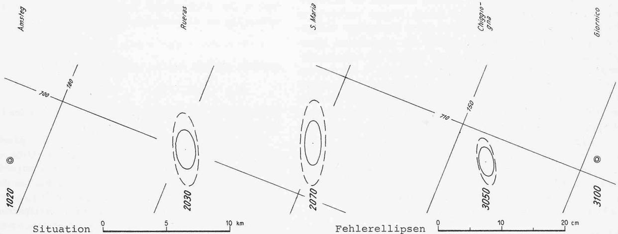
Bild 4. Einflusscharakteristik des Netzes auf den mittleren Querfehler unter beliebigem Durchschlagsort bei einer Absteckung von den Portalen aus (oben). Fehlererellipsen der Schachtanschlüsse bezüglich der Portalpunkte 1020, 3100 (unten)
