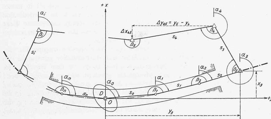
Bild 1.  $x$ -Achse senkrecht zur Bauachse (strichpunktierte Linie), in der Durchschlagstelle  $D = 0$  ( $x_D = x_0 = 0, y_D = y_0 = 0$ ),  $n$  Stationen, aussen (Dreiecke), innen (Kreise), Winkelmessungen  $\beta_i$ , Distanzmessungen  $s_i$
