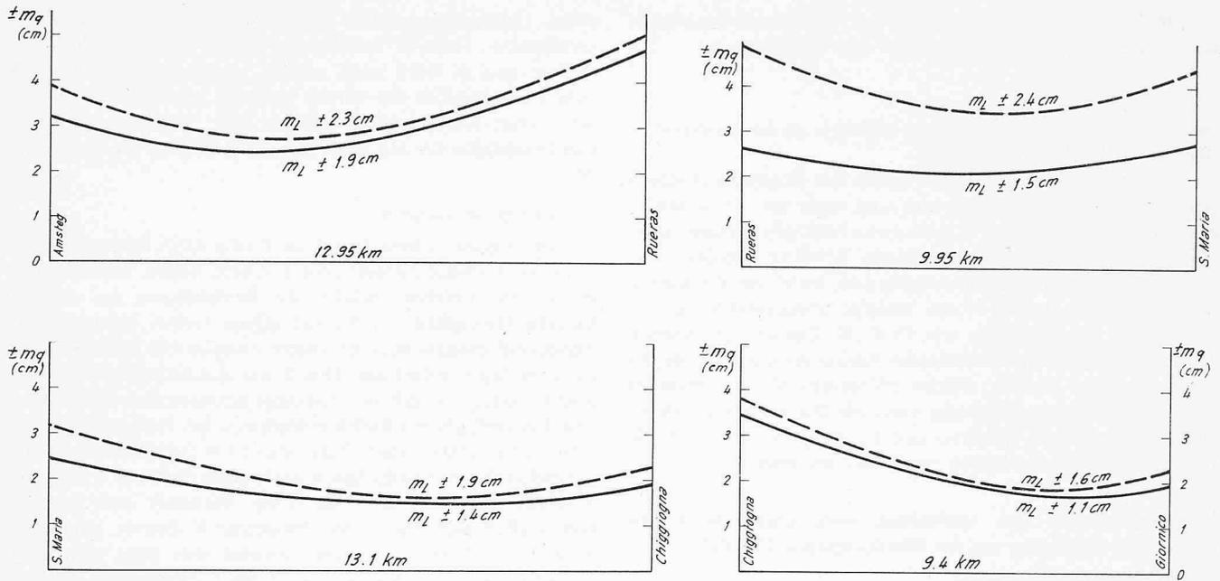
Bild 3. Einflusscharakteristik des Netzes auf den mittleren Durchschlagsfehler in Querrichtung für die Bauabschnitte bei beliebigem Durchschlagsort zwischen den Angriffsstellen
