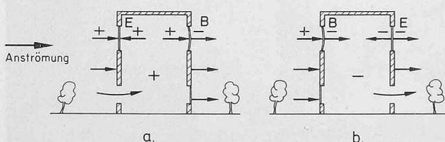
Bild 7. Belastung der Fenster (B Belastet, E Entlastet)
