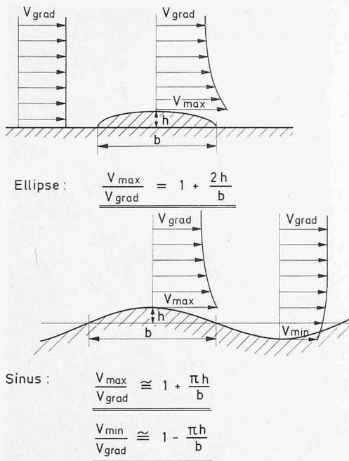
Bild 5. Einfluss von Geländeform auf Geschwindigkeit (reibungsfrei)
