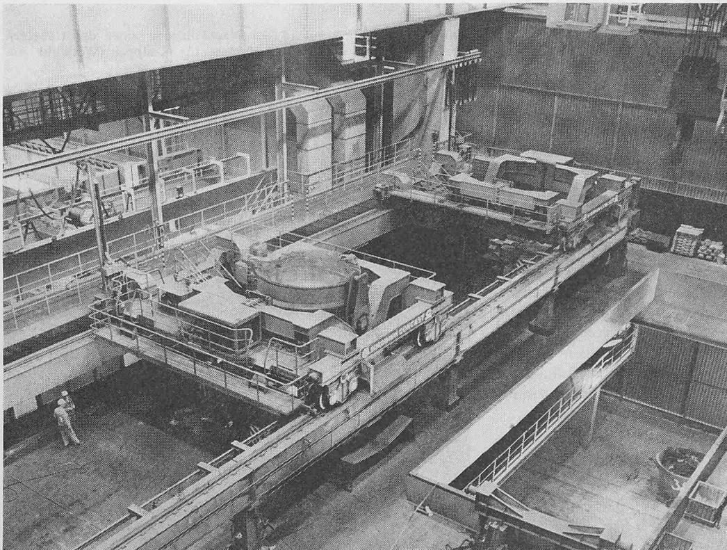
Bild 7. Giessbühne einer modernen Brammengiessanlage mit Pfannenwagen. Der eigentliche Giessstand ist auf diesem Bild, durch Pfanne und Wagen verdeckt, nicht sichtbar (Werkbild August Thyssen-Hütte AG, Deutschland)
