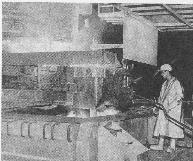
Bild 8. Giessstand der in Bild 7 gezeigten Anlage mit, von oben nach unten, Giesspfanne, Zwischenbehälter, Tauchausguss und Kokillentisch
