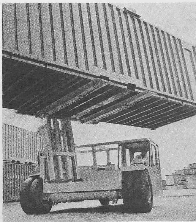
Bild 3. Gabelstapler «Swinglift 200 WT» mit Drehvorrichtung für den Behälter
