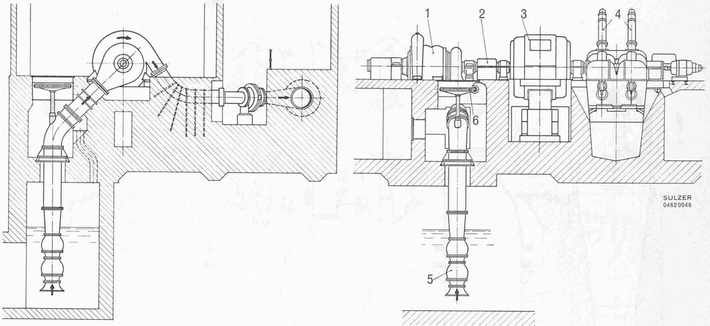
Bild 7. Maschinensatz in der Zentrale Motec der Aluminium-Industrie AG. 1 dreistufige, einflutige, horizontale Speicherpumpe, gebaut für  $H = 628$  m,  $Q = 3,26$  m<sup>3</sup>/s,  $n = 750$  U/min,  $P_M = 80$  760 PS; 2 Kupplung, 3 Synchronmaschine; 4 Freistrahlturbine mit zwei Laufrädern; 5 Zubringerpumpe; 6 Freistrahlf-Hilfturbine zum Antrieb von 5. Eine ausführliche Beschreibung dieses Kraftwerkes findet sich in SBZ 80 (1962), H. 28, S. 493
