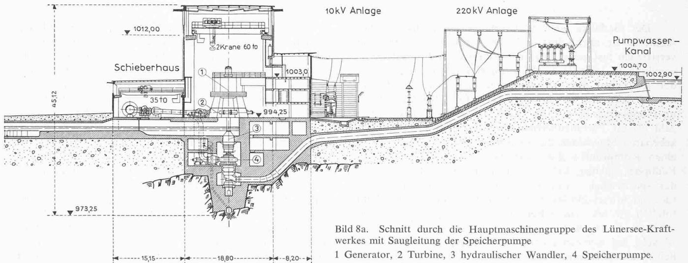
Bild 8a. Schnitt durch die Hauptmaschinengruppe des Lünensee-Kraftwerkes mit Saugleitung der Speicherpumpe
