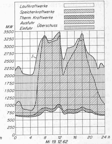
Bild 2. Vergleich der Mittwoch-Lasten und der Erzeugungsarten im Sommer und im Winter des Jahres 1962
