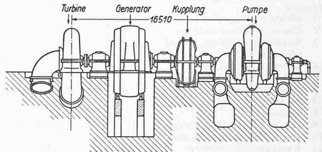
Bild 4. Speichergruppe des Kraftwerkes Herdecke/Ruhr. Horizontale, zweistufige, doppelflutige Pumpen mit regulierbarem Leitapparat, gebaut für  $H = 146,4$  m,  $Q = 14,6$  m<sup>3</sup>/s,  $n = 300$  U/min,  $P_M = 36$  100 PS; aus [5]
