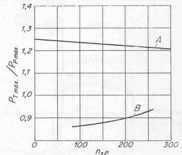
Bild 12. Verhältnis der maximalen Turbinenleistung zur maximalen Pumpenleistung in Abhängigkeit von der spezifischen Drehzahl der Pumpe. A Pumpenturbine mit verstellbaren Leitschaufeln, B Pumpenturbine mit festen Leitschaufeln
