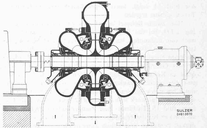
Bild 14. Horizontale, einstufige, doppelflutige Pumpenturbine für die Zentrale Staffel der Grande Dixence S. A.
