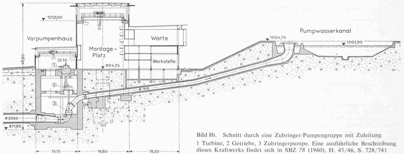
Bild 8b. Schnitt durch eine Zubringer-Pumpengruppe mit Zuleitung
