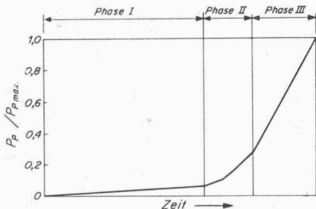
Bild 10. Verlauf des verhältnismässigen Leistungsbedarfs einer ausgeblasenen Pumpenturbine beim Anfahren als Pumpe
