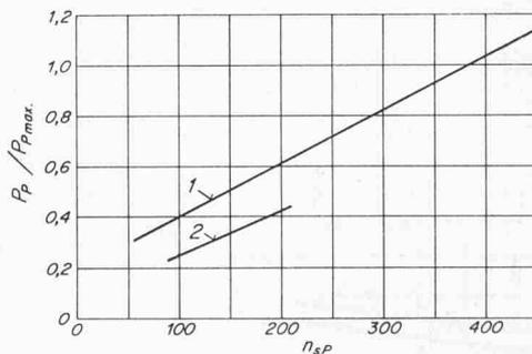
Bild 11. Anstieg des verhältnismässigen Leistungsbedarfs einer Radialpumpenturbine bei geschlossenem Schieber in Abhängigkeit von der spezifischen Drehzahl. 1 Leitapparat offen, 2 Leitapparat geschlossen
