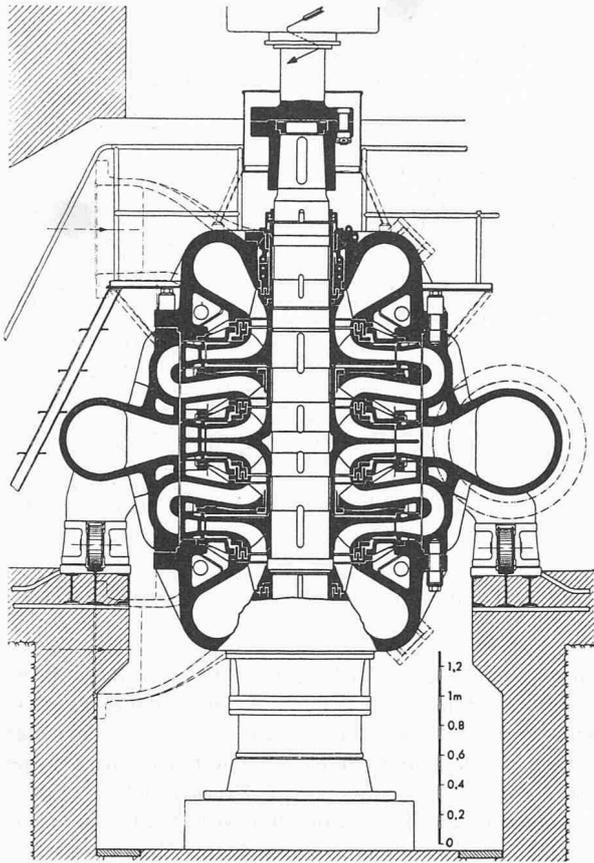
Bild 3. Zweistufige, doppelflutige, vertikale Speicherpumpe des Kraftwerkes Oberaar der Kraftwerke Oberhasli AG, gebaut für  $H = 400$  m,  $Q = 4$  m<sup>3</sup>/s,  $n = 1000$  U/min,  $P_M = 25$  100 PS; aus [5]
