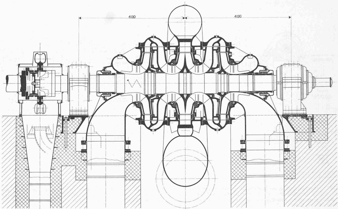
Bild 9. Längsschnitt durch die zweistufige, doppelflutige Speicherpumpe des Kraftwerkes Vianden
