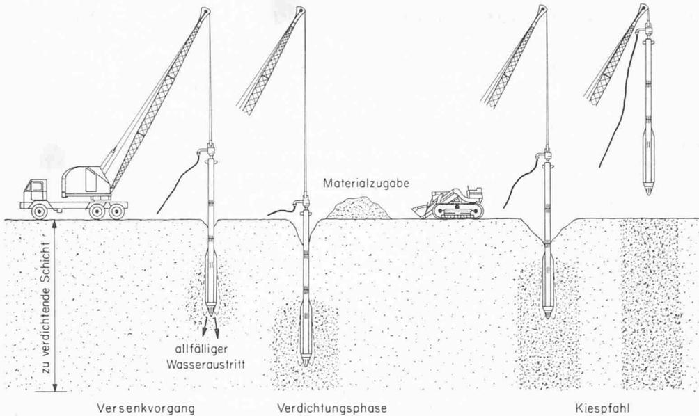
vorgang so oft wiederholt, bis zur vorgeschriebenen Fundamentkote ein zylinderförmig verdichteter Erdkörper entstanden ist. Die Umlagerung erfolgt spannungsfrei, der Erdkörper ist auch gegen Erosion weitgehend unempfindlich, und damit die Verdichtung eine dauernde. Infolge der Porenvolumenverminderung des Bodens entsteht an der Oberfläche ein Trichter (Bild 4), in welchen zum Ausgleich laufend Material zugegeben wird.
