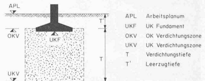
Bild 6. Vergrößerung der Verdichtungsfläche gegenüber Fundamentfläche
