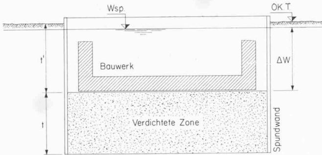
Bild 10.  $k$ -Wert-Reduktion innerhalb von Spundwänden.  $t$  = Verdictungstiefe,  $t'$  = Leerzugtiefe
