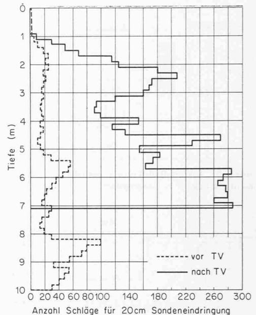
Bild 8. Rammsondierung vor und nach Durchführung der Tiefenverdichtung (TV). Bärgewicht 30 kg, Fallhöhe 20 cm, Spitzenquerschnitt 10 cm<sup>2</sup>
