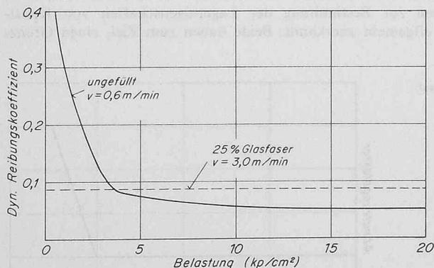
Bild 4. Dynamischer Reibungskoeffizient von PTFE in Funktion der Belastung
