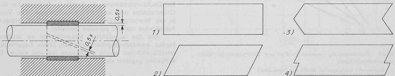
Bild 7. Bewährte Einbauverhältnisse und Folienzuschnitte für Schlitzringlager aus PTFE. Links Einbauverhältnisse,  $s$  Foliendicke. 1 bis 4 typische Endschnitte
