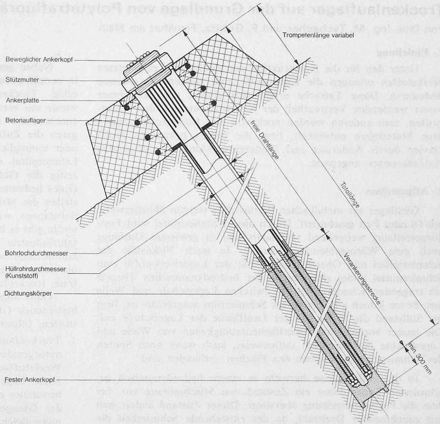
Bild 14 (rechts). Gründungsanker BBRV, Spezialausführung für die Konsolidierung in Bissone. Dauernde Erhaltung der Nachstellbarkeit, Korrosions-Schutz mit plastischer Masse
