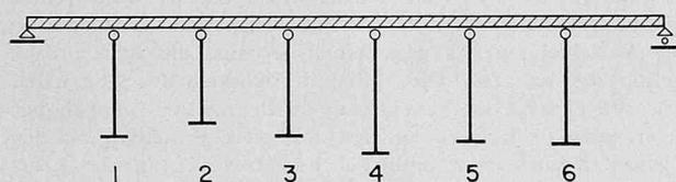
Bild 8. Statisches System einer Brücke im Endzustand
