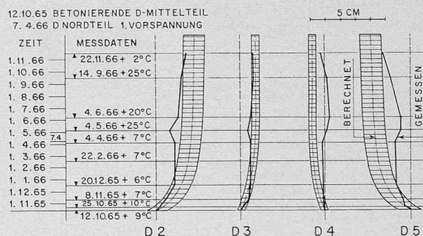
Bild 17. Brücke D: Berechnete und gemessene Pfeilerkopfbewegungen
