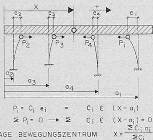
$C_i$  = PFEILERKOPFSCHUB INFOLGE EINHEITSAUSLENKUNG  $e=1$
