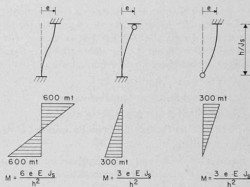
Bild 11. Biegemomente bei drei Stützen infolge Auslenkung
