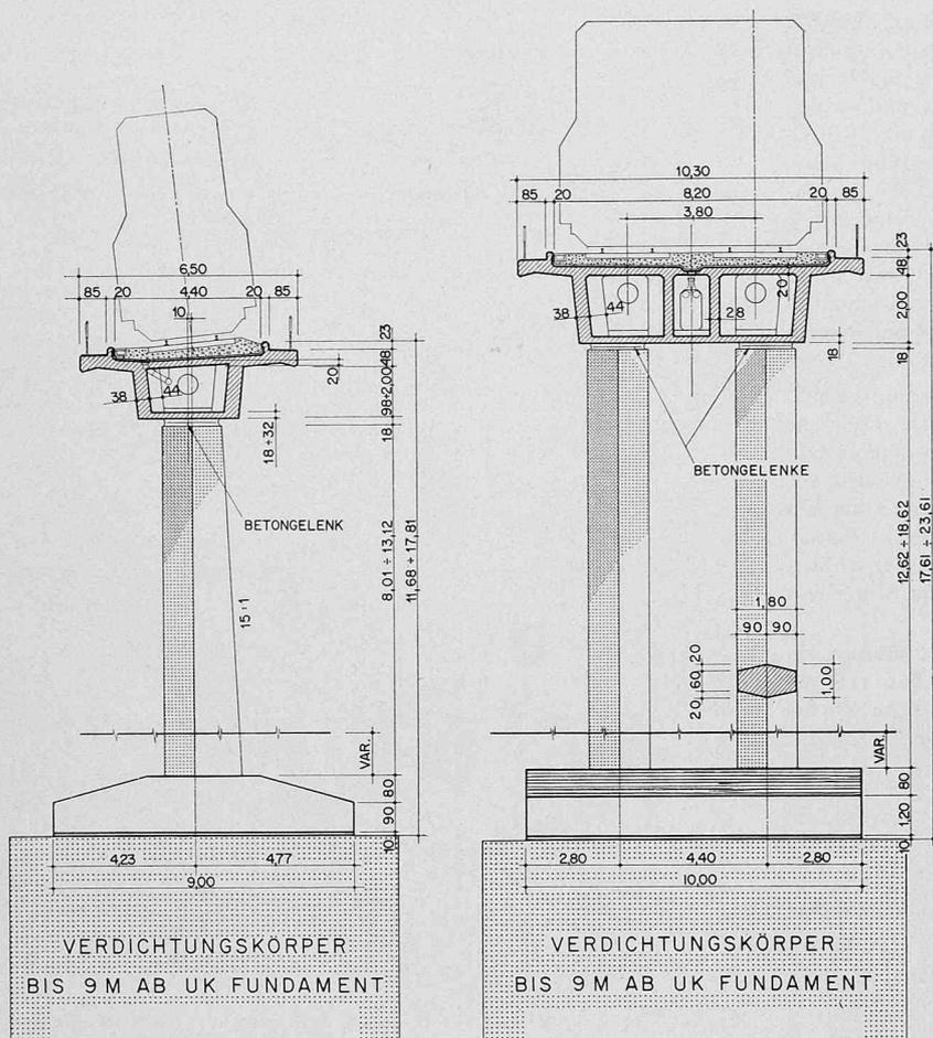
Bild 7. Normalquerschnitte 1:250, links eingleisig, rechts zweigleisig
