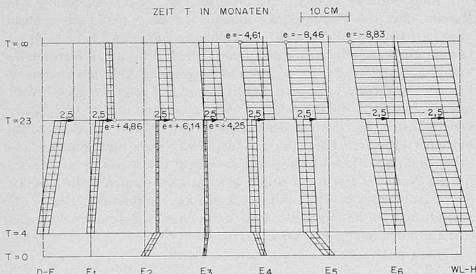
Bild 16. Brücke E: Pfeilerkopfbewegungen in Funktion der Zeit
