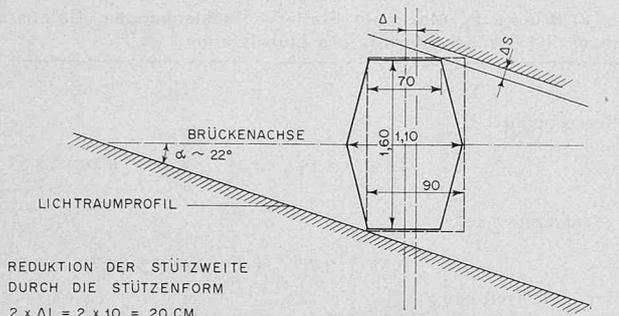
REDUKTION DER STÜTZWEITE
