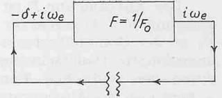
Bild 3. Beim inversen Frequenzgang  $F = 1/F_0$  sind Eingang und Ausgang vertauscht. Bei Eingabe einer gedämpften Schwingung mit  $p = -\delta + i \omega_e$  am Eingang entsteht also am Ausgang eine ungedämpfte Schwingung  $p = i \omega_e$ . Auf Grund der Beziehung zwischen  $F$  und  $F_0$  lässt sich mit dem Computer die Abklinggrösse  $\delta$  und die Eigenfrequenz  $\omega_e$  bestimmen.
