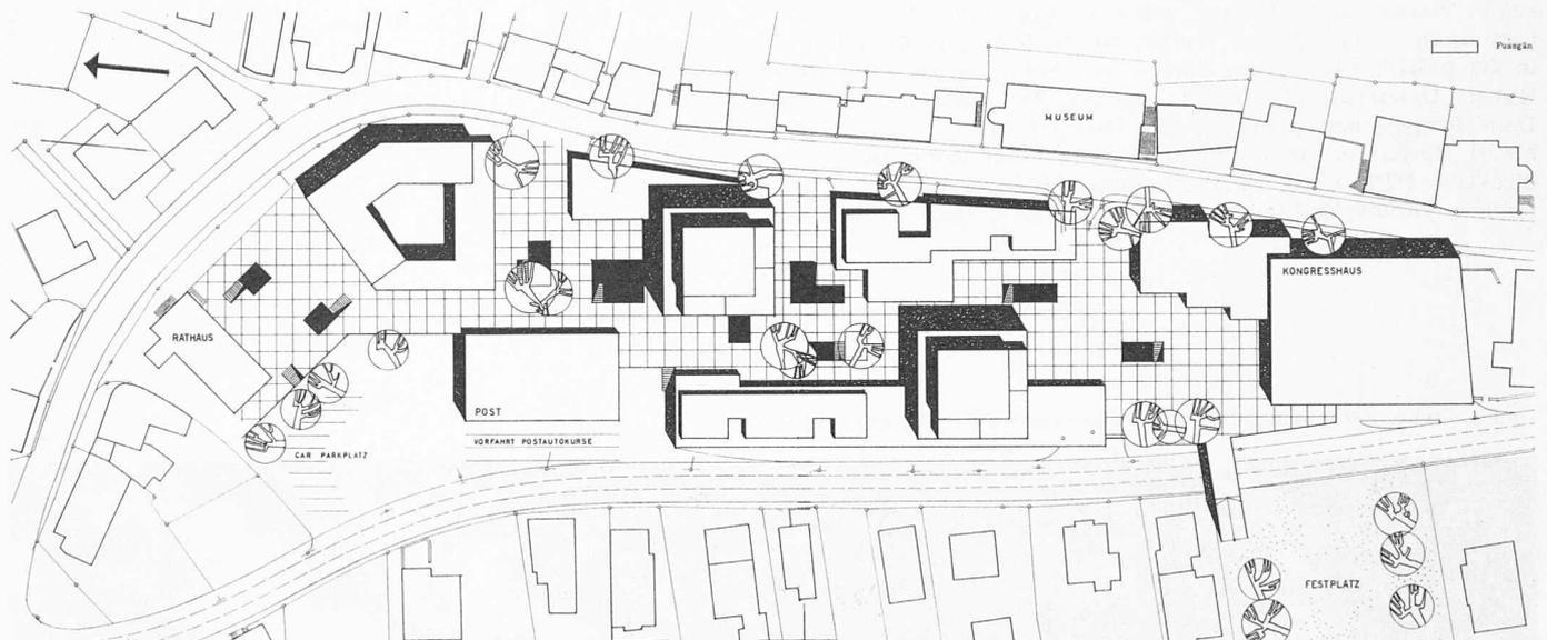
Bild 4. Das Parkgeschoss (1:2000) enthält 330 Abstellplätze für Kurzparker. Es wird bequem von der niveaugleichen Aeulestrasse aus erreicht. Ein- und Ausfahrten sind zusammengefasst. Darunter befindet sich nochmals ein Parkgeschoss kombiniert mit Kellerräumen, das für Dauerparker bestimmt ist
