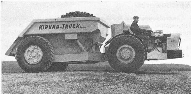
Bild 1. Diesel-Rückwärtskipper, Ladefähigkeit bis 21 t (15 m<sup>3</sup>)
