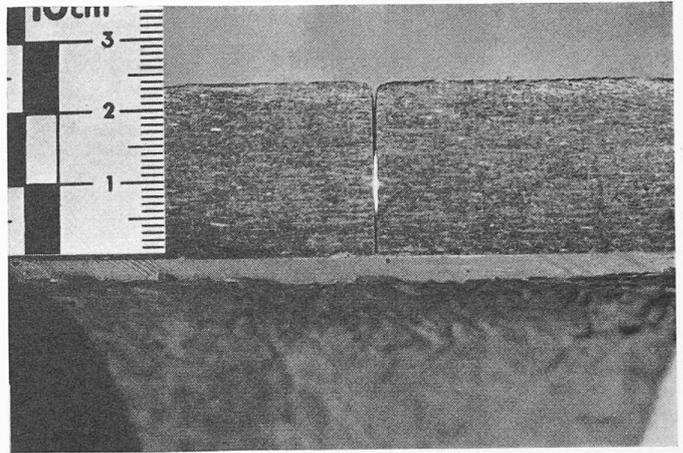
sich infolge ihrer geringen Bruchdehnung unmittelbar nach dem Auftreten der ersten Haarrisse im Beton von diesem zu lösen. Nach dem vollständigen Zugriss im Betonkörper war der Polyesterbelag auf die ganze Länge des 16 cm langen Probekörpers abgelöst, ohne selbst gerissen zu sein (Bild 7). Durch allmähliche Ablösung vom Beton schaffte sich der Polyesterbelag zur Ueberbrückung des entstehenden Risses im Beton die seiner Elastizität entsprechende freie Dehnungsmöglichkeit (Bild 3).
