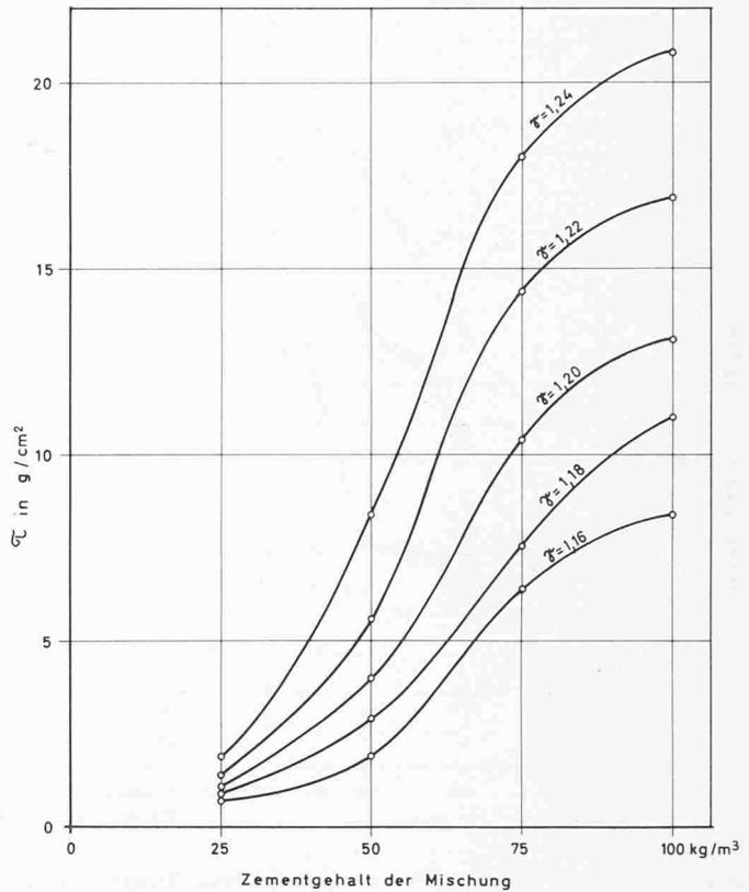
Bild 8. Kohäsion von Tongel im Alter von fünf Stunden, Ton von Holderbank
