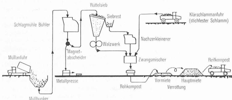
Bild 4. Schema des Bühler-Verfahrens (nach Allenspach, 1958)
