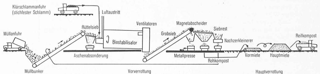
Bild 2. Schema des Dano-Biostabilisator-Verfahrens (nach Allenspach, 1958)
