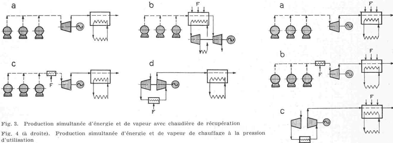
Fig. 3. Production simultanée d'énergie et de vapeur avec chaudière de récupération
