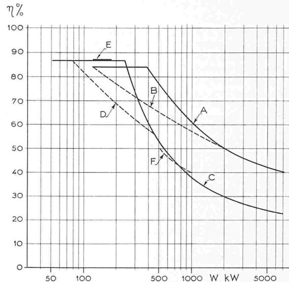
Fig. 7. Rendement thermique global  $\eta$  en fonction de la puissance électrique spécifique  $W$  en kWh/10<sup>6</sup> kcal.
