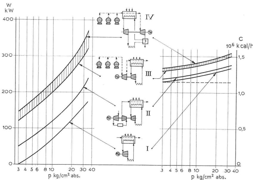
Fig. 5. Puissance électrique W et consommation horaire de combustible C pour un chauffage de 10<sup>6</sup> kcal/h en fonction de la pression de vapeur p
