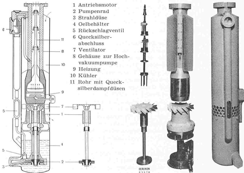
Bild 1. Die Oerlikon-Hochvakuum-Strahlpumpe
