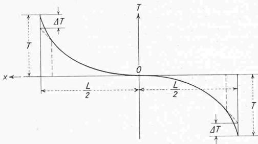
Bild 7. Verteilung der Schubkräfte am Schalenrand
