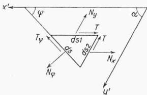
Bild 4. Spannungen am Flächenelement in der  $\psi$ -Richtung
