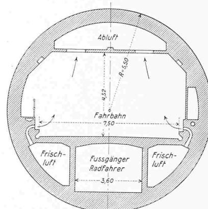
Tunnelquerschnitt 1 : 200
