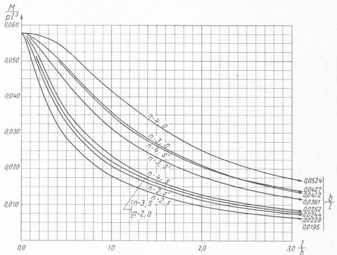
Diagramm 6:  $p = \text{konst.}$ ,  $M_R$  im Randträger
