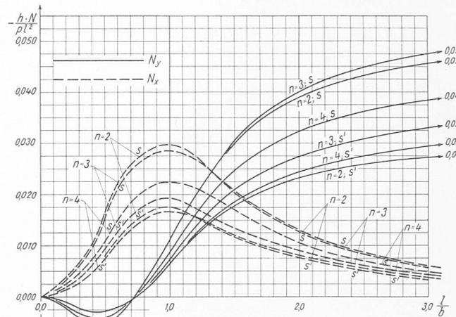
Diagramm 10:  $p = \text{konst.}, N_y, N_x$  in Plattenmitte
