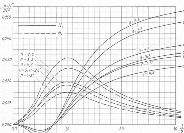
Diagramm 9:  $p = \text{konst.}, N_y, N_x$  in Plattenmitte
