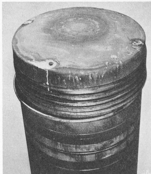
Bild 13. Spülseite des Kolbens von 720 mm Nenndurchmesser nach 220 Stunden Dauerbetrieb mit Schweröl von 3000 sec. Redwood I
