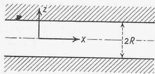
Es wird eine Flüssigkeit mit temperaturunabhängigen Stoffwerten betrachtet. Sie ströme mit ausgebildetem Poiseuille-Profil in der  $x$ -Richtung zwischen zwei Platten mit dem Abstand  $2R$ . Die Geschwindigkeit ist:
