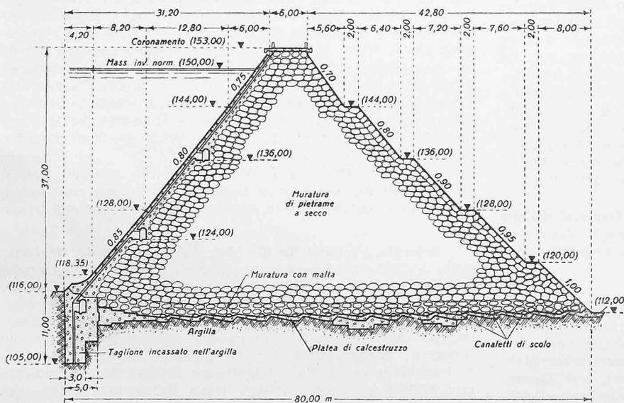
Bild 2. Querschnitt 1:800 durch den Damm aus Trockenmauerwerk.
