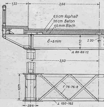
Bild 16. Querschnitt durch Fahrbahn und Bogenkonstruktion; 1:100
