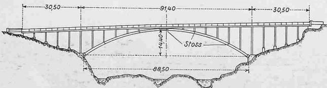
Bild 15. Hauptabmessungen der Brücke bei Arvida, 1:2000
