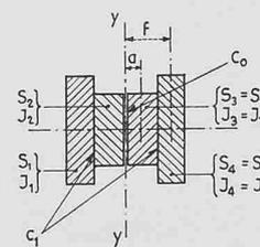
Bild 6. Vierteiliger Druckstab
