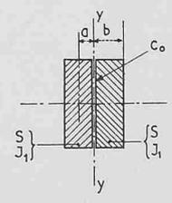
Bild 7. Zweiteiliger Druckstab
