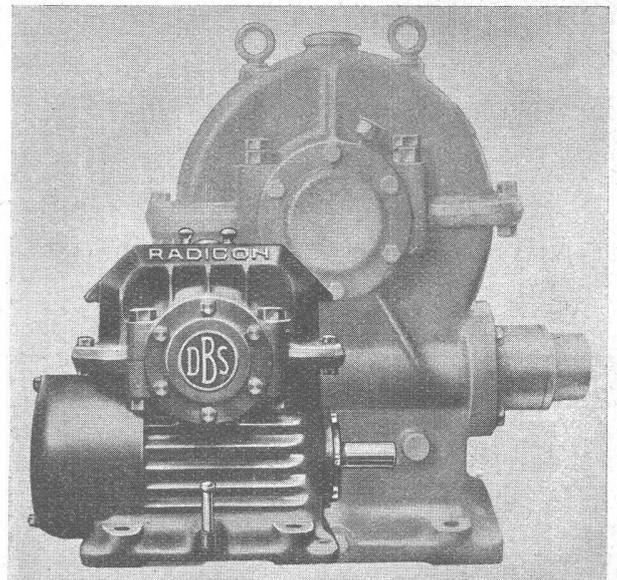
Sonderkühlung, Öelumlaufrschmierung für Getriebe und Lager, David Brown Schneckenform, hohe Leistung und Wirkungsgrad bei kleinsten Abmessungen, niedrigerer Preis als für gewöhnliche Schneckengetriebe gleicher Leistung, zuverlässig, geräuschlos.
