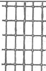
**Drahtziegelgewebe und Streckrabitz** die beiden bevorzugten Putzmörtelträger
