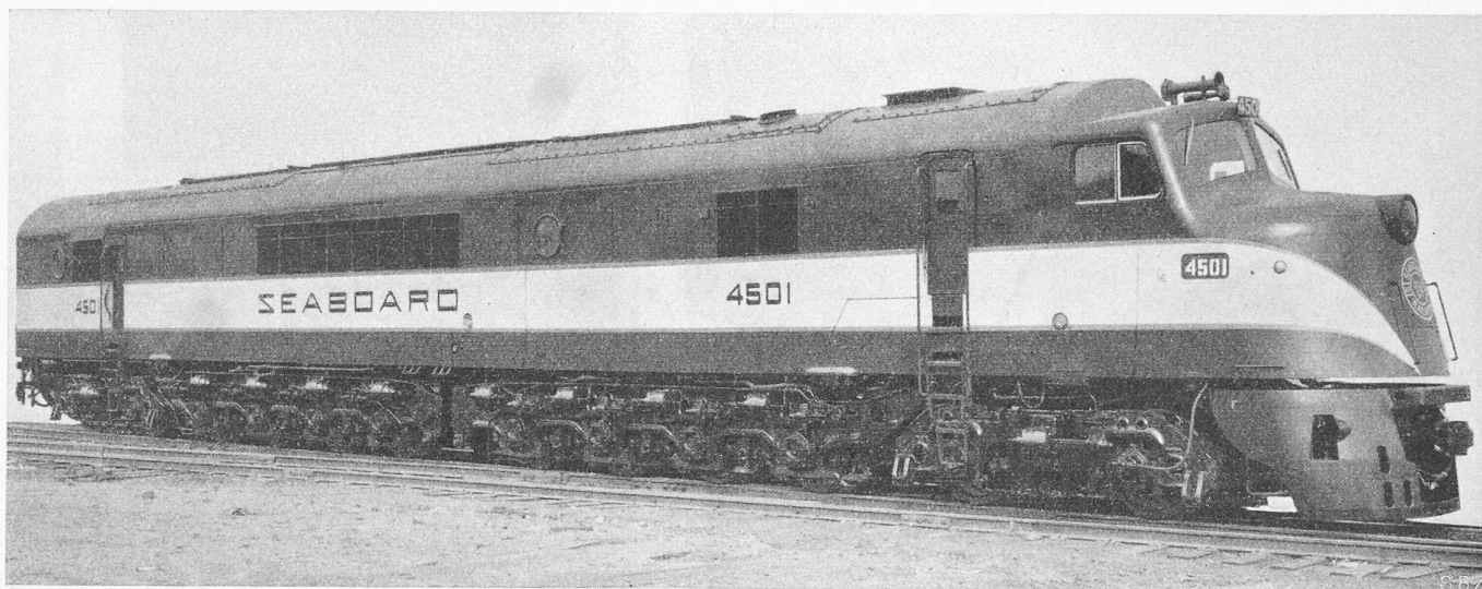
Bild 3. Diesel-elektrische Lokomotive der Baldwin Locomotive Works, Achsfolge 2 D 0 - D 0 2 von 3000 PS
