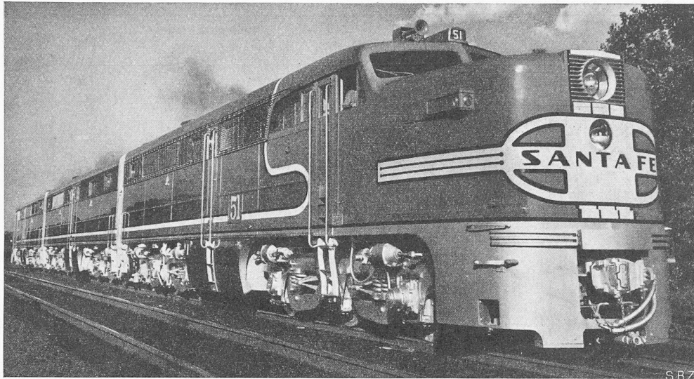
Bild 8. Diesel-elektrische Lokomotive der American Locomotive Co., bestehend aus drei Einheiten zu je 2000 PS
