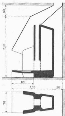
Bild 2. Kamin-Ofen. Grundriss u. Schnitt 1 : 80
