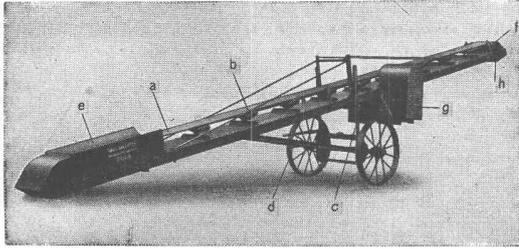
Die Einschaltung zuverlässig arbeitender Gurttförderer „RACO“ auf Raupenbänder laufender Becherwerksauf- lader oder anderer Fördergeräte, die wir als Spezialität liefern, vermag bei Steigerung der Leistungsfähigkeit die Transportkosten bedeutend zu reduzieren.
