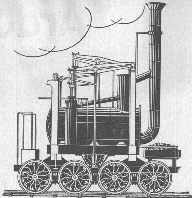
1815: Hedley's 2. Lokomotive besaß 4 Triebachsen mit Zahnradübertragung
