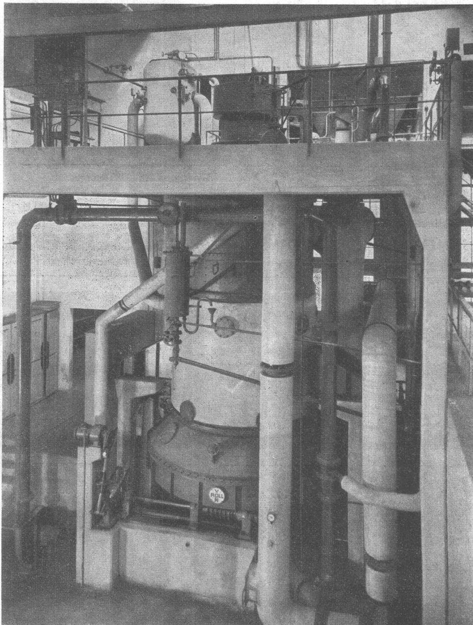
„VOGO“ Drehrostgaserzeuger für eine Maximalleistung von 3 000 000 kcal/h
