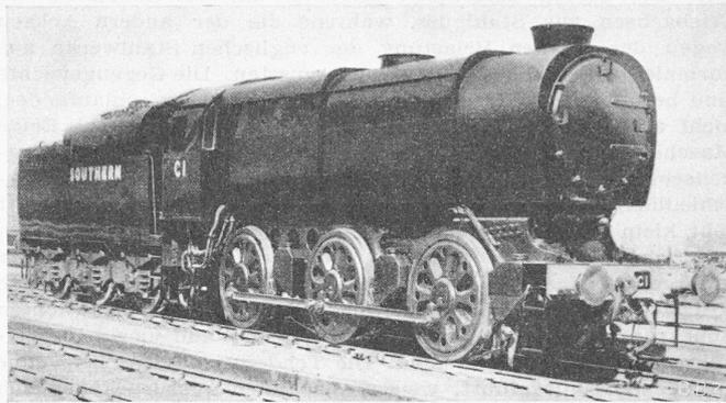
Bild 2. Güterzuglokomotive der Reihe Q1 der Southern Railway
