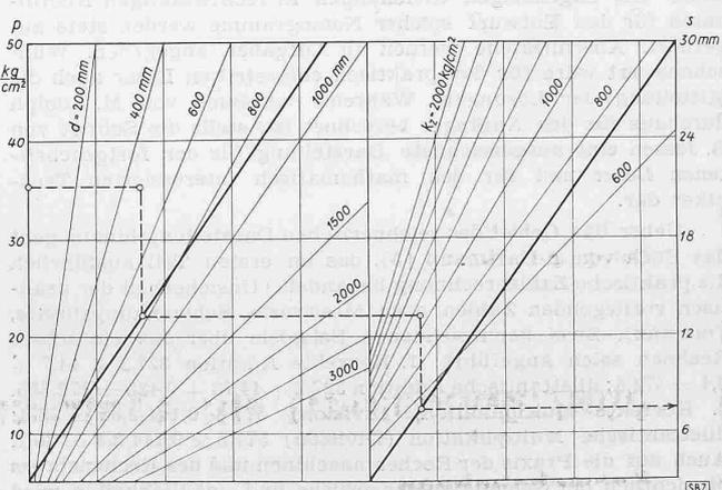
Abb. 3. Graph. Verfahren auf Grund der Leitlinie zur Bestimmung der Rohrwandstärke aus Druck, Rohrdurchmesser und zulässiger Festigkeit, nach H. Diercks und H. Euler
