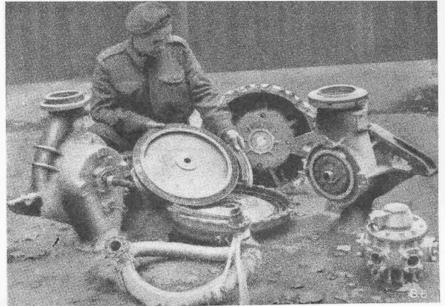
Abb. 8. Demontiertes Aggregat; das Turbinenlauftrad und die Segmente des Leitrades sind sichtbar. Im Vordergrund die mit Glaswolle isolierte Turbinenleitung und ein Sauerstoffverteiler
