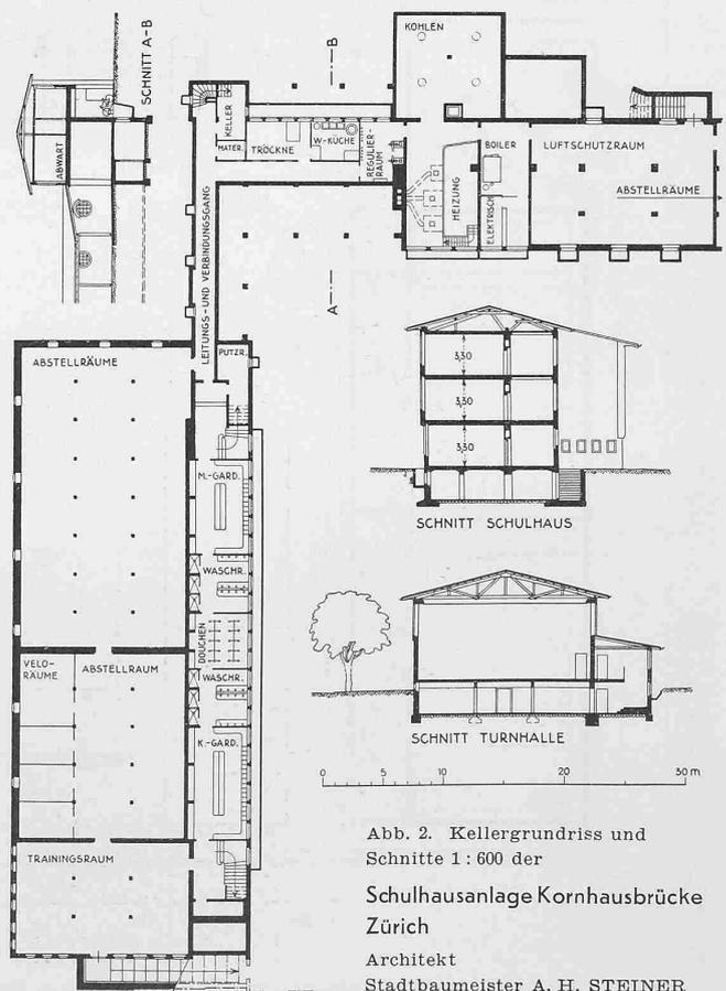
Abb. 2. Kellergrundriss und Schnitt 1:600 der
