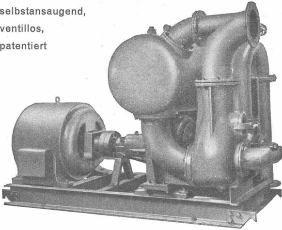
Saughöhen bis 9 m, Leistungen 1—500 Liter/Sek. Keim Bodenventil · Keine Klappe im Saugstutzen · Keine Hilfs-Vakuum-Pumpe · Jederzeitiges automatisches Ansaugen auch nach Lufttritt im Saugrohr. Keine reibenden, sich abnützenden Flächen, daher unempfindlich gegen Sand, Schlamm und Kies.
