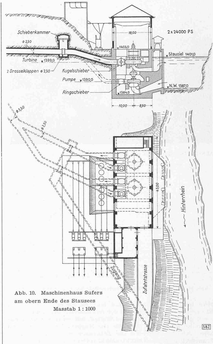
Abb. 10. Maschinenhaus Sufers am oberen Ende des Stausees
