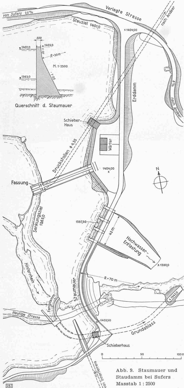
Abb. 9. Staumauer und Staudamm bei Sufers
