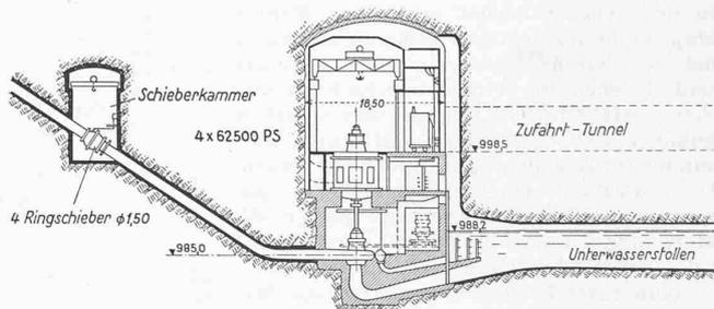
Abb. 12. Unterirdisches Maschinenhaus Anderer. — Masstab 1 : 1000
