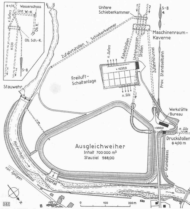
Abb. 11. Kraftwerk Anderer mit Ausgleichsweiher. — Masstab 1 : 8000
