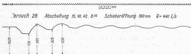
Abb. 9. Druckschwankungs-Diagramm eines Abschaltversuches
