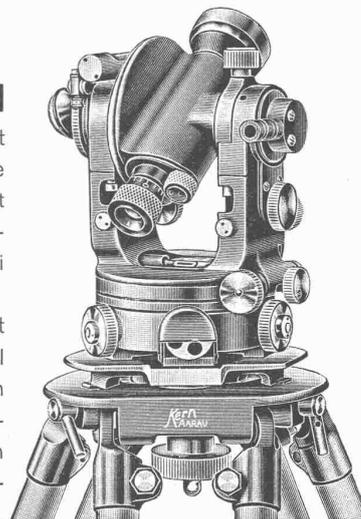
Gewicht des Instrumentes nur 1,8 kg, Gewicht des Metallbehälters 1 kg, Gewicht des Stativs ca. 3 kg.
