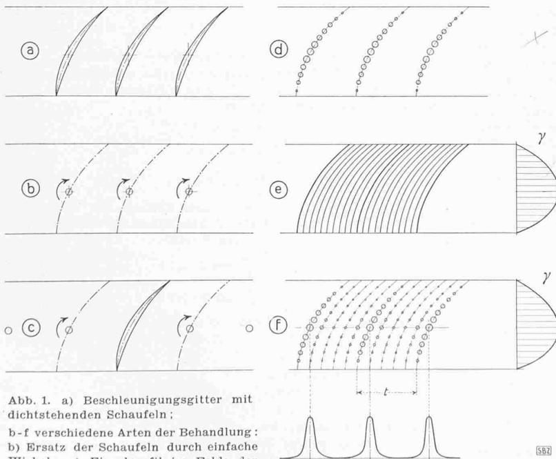
Abb. 1. a) Beschleunigungsgitter mit dichtstehenden Schaufeln; b-f verschiedene Arten der Behandlung: b) Ersatz der Schaufeln durch einfache Wirbel; c) Einzelprofil im Felde der durch Wirbel ersetzten übrigen Schaufeln; d) Schaufel als lineare Reihe von Wirbeln; e) unendlich grosse Schaufelzahl, kontinuierliche, aber nur von einer Koordinate abhängige Zirkulationsverteilung; f) periodische Zirkulationsverteilung
