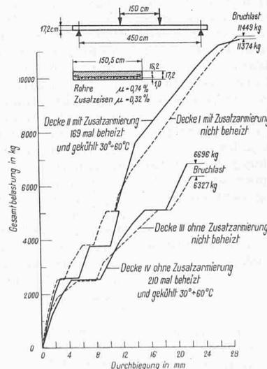
Abb. 7. Ergebnisse von statischen Belastungsversuchen an Decken I bis IV. Belastungs-Durchbiegungs-Diagramme
