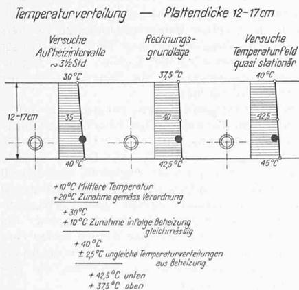
Abb. 6. Mittelwerte der Temperaturverteilung bei Strahlungsheizungsdecken entsprechend Messung und der Rechnungsannahme
