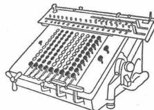
rechnen Sie dank der vereinfachten, automatischen Rückübertragungsvorrichtung der Zwischenergebnisse ins Einstellwerk z. B.  $0,275 \times 1,22 \times 3,14 = 1,054$
